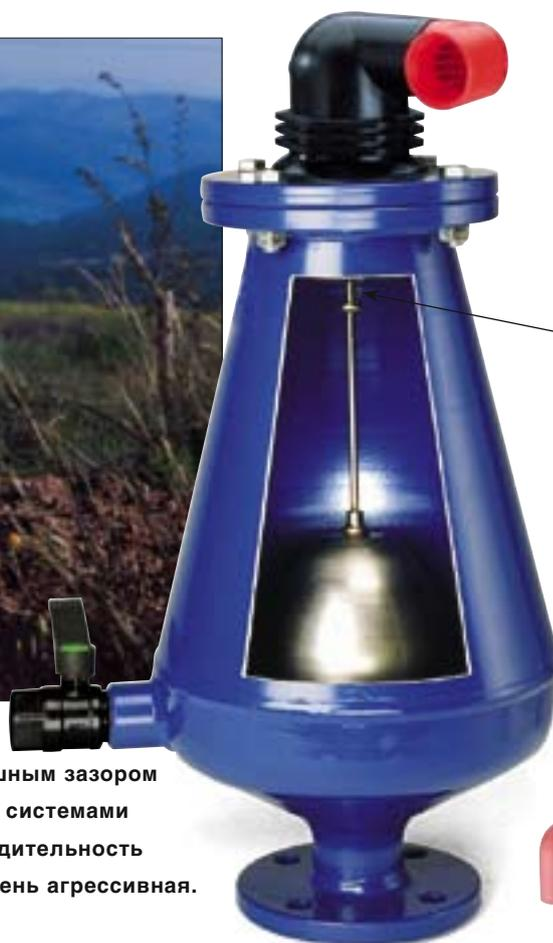
Во время наполнения линии воздух при высоком расходе выпускается через отверстие кинетического клапана – до полного заполнения линии.
