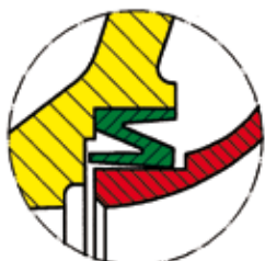
Кольцо износа в ходе эксплуатации
